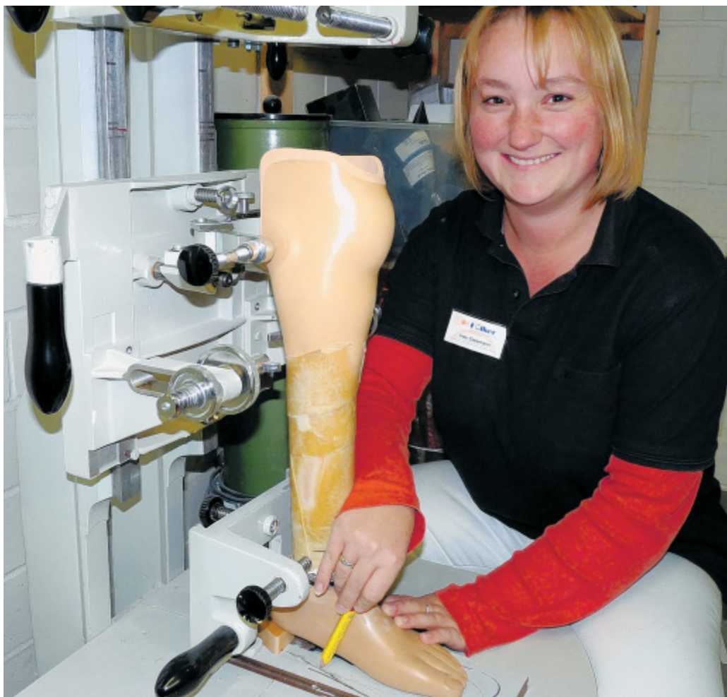
Feinarbeit: Ines Sielemann misst am Prothesen-Aufbaugerät, ob das Produkt auch richtig ausbalanciert ist.
